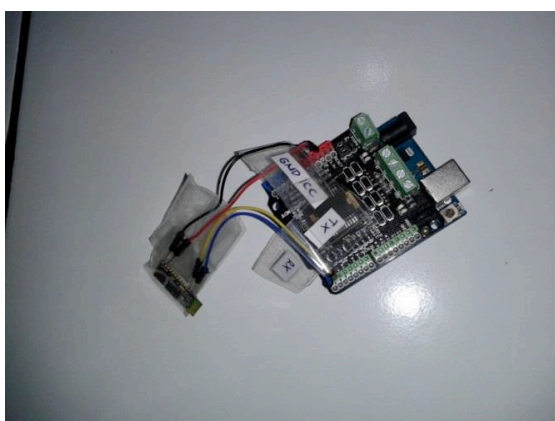
Gambar 2.7. Rangkaian Modul Bluetooth HC-05
