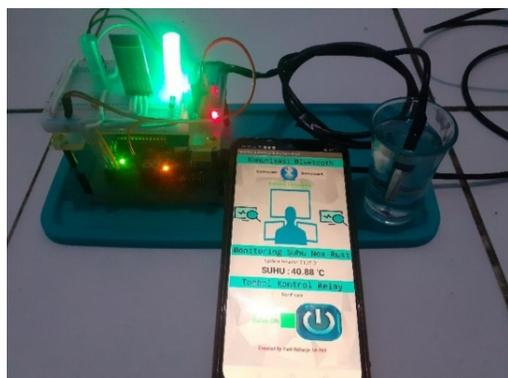
Gambar 4.26 Hasil Pengujian Tombol Kontrol diONkan
