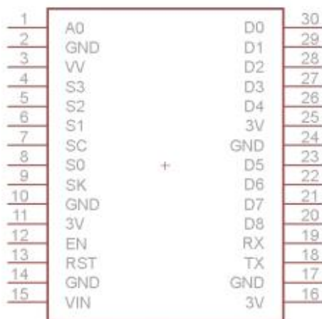
Gambar 2. Rangkaian NodeMCU ESP8266
