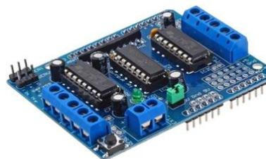
Gambar 1. Bentuk Fisik motor shield L293D
