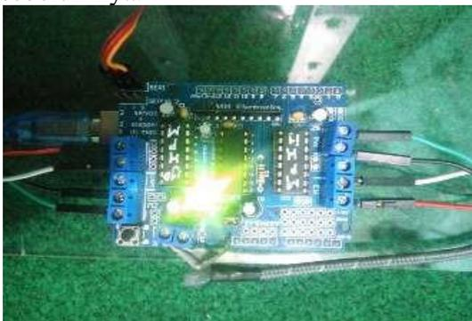
**Gambar 10. Rangkaian Shield L293D setelah perakitan**
