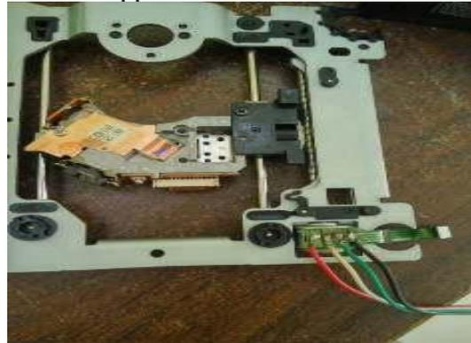
**Gambar 12. Rangkaian Motor Stopper Y**
